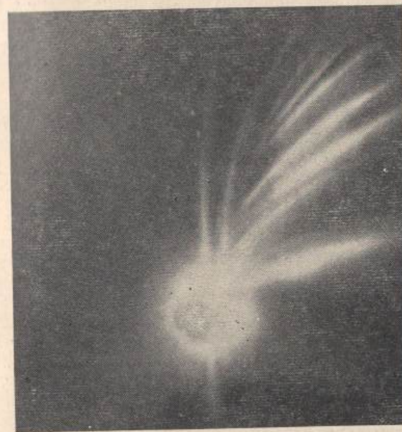
Рис. 2.9. Спектр парабол для легких инертных газов [Proc. Roy. Inst., 20 (1913), стр. 596, рис. 3].
