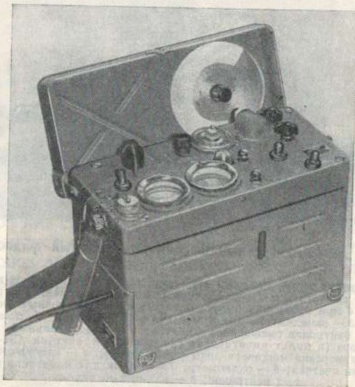
Рис. 33. Переносная установка РВ-4 для измерения концентрации радиоактивных аэрозолей в воздухе.
