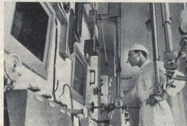
Рис. 44. Механический (копирующий) манипулятор для работы с изотопами большой активности.
