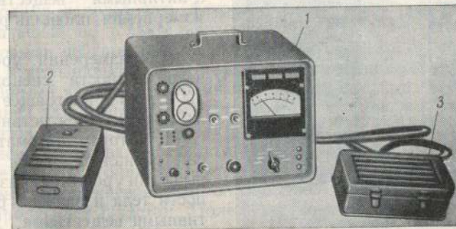
Рис. 34. Универсальный радиометр типа ТИСС для измерения загрязненности поверхностей, рук и одежды 1 — датчик ТГ для измерения загрязненности \beta -, \gamma -активными веществами; 2 — измерительный пульт; 3 — датчик ТЮ для измерения загрязненности \alpha -активными веществами.
