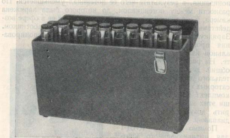
Рис. 39. Конденсаторные камеры комплекта КИД-1.
